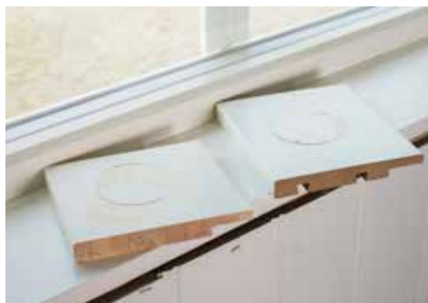
Kafferinger som har tørket inn. Testen gjennomføres med malt utføring til venstre og G-Fix utføring til høyre.
