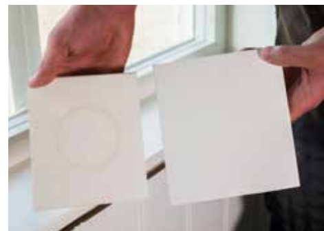
Resultatet: tydelig markert ring på malt utføring til venstre, ingen merker på G-Fix utføring til høyre.
